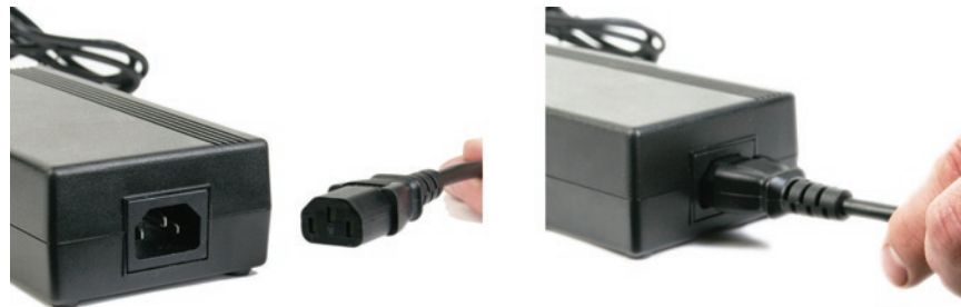
Figura 2-14. Connessione del cavo di alimentazione elettrica all'alimentatore
